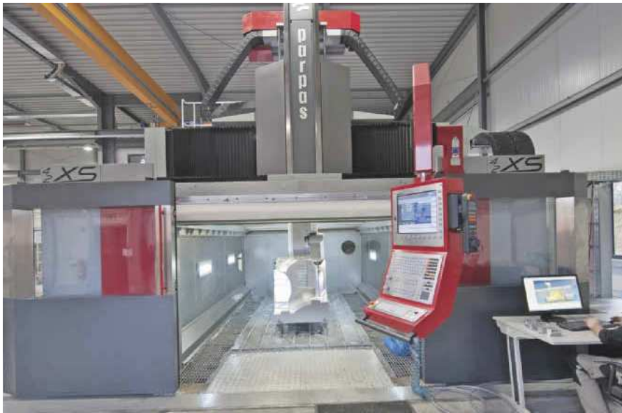
Die Parpas XS bei Peter Schmitz Formenbau bietet nutzbare Verfahrenswege von 4 \times 2,5 \times 1,5 \text{ m}^3 Bilder, wenn nicht anders gekennzeichnet: Klaus Hennecke
